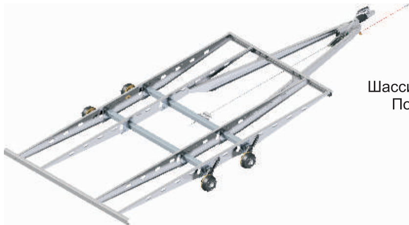
Шасси для прицепов д/перевозки автомобилей Полная масса прицепа до 3500 кг
